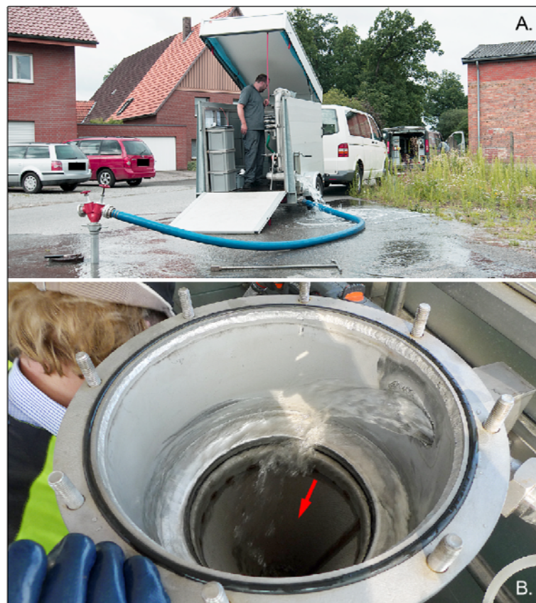
Abb. 4: A. Mobile Beprobungs- und Filterapparetureinheit der Firma Scheideler Verfahrenstechnik GmbH B. Roter Pfeil markiert die Position der 100 µm-Filtereinheit
